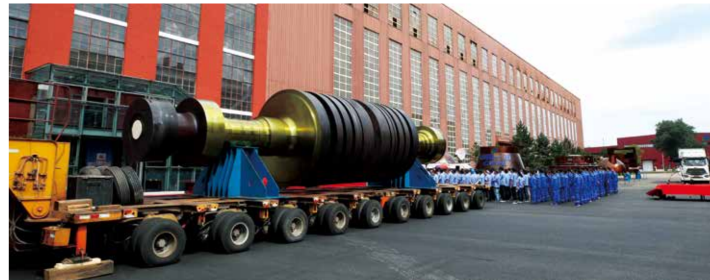
百万千瓦级核电整锻低压转子
